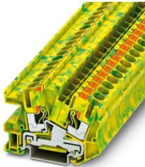
Installations-Schutzleiterklemme, Nennspannung: 800 V, Push-in-Anschluss, Bemessungsquerschnitt: 6 mm<sup>2</sup>, Querschnitt: 0,5 mm<sup>2</sup> - 10 mm<sup>2</sup>, Montageart: NS 35/7,5, NS 35/15, Farbe: grün-gelb
