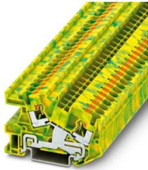
Installations-Schutzleiterklemme, Push-in-Anschluss, 1. Etage, Bemessungsquerschnitt: 4 mm<sup>2</sup>, Querschnitt: 0,2 mm<sup>2</sup> - 6 mm<sup>2</sup>, Montageart: NS 35/7,5, NS 35/15, Farbe: grün-gelb
