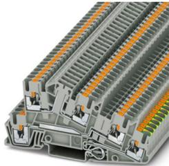
Installations-Schutzleiterklemme, Strom und Spannung werden durch den eingesetzten Stecker bestimmt., Nennspannung: 400 V, Thermischer Dauerstrom  $I_{th}$ : 24 A, Push-in-Anschluss, Bemessungsquerschnitt: 2,5 mm<sup>2</sup>, Querschnitt: 0,14 mm<sup>2</sup> - 4 mm<sup>2</sup>, Push-in-Anschluss, Querschnitt: 0,14 mm<sup>2</sup> - 4 mm<sup>2</sup>, Montageart: NS 35/7,5, NS 35/15, Farbe: grau
