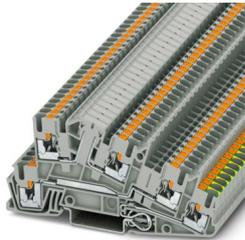
Installations-Schutzleiterklemme, Nennspannung: 400 V, Nennstrom: 24 A, Push-in-Anschluss, 1., 2. und 3. Etage, Bemessungsquerschnitt: 2,5 mm<sup>2</sup>, Querschnitt: 0,14 mm<sup>2</sup> - 4 mm<sup>2</sup>, Montageart: NS 35/7,5, NS 35/15, Farbe: grau
