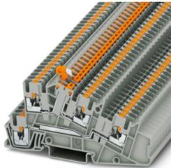
Installationsetagenklemme, Nennspannung: 400 V, Nennstrom: 24 A, Push-in-Anschluss, Bemessungsquerschnitt: 2,5 mm<sup>2</sup>, Querschnitt: 0,14 mm<sup>2</sup> - 4 mm<sup>2</sup>, Push-in-Anschluss, Bemessungsquerschnitt: 1,5 mm<sup>2</sup>, Querschnitt: 0,14 mm<sup>2</sup> - 4 mm<sup>2</sup>, Montageart: NS 35/7,5, NS 35/15, Farbe: grau
