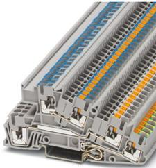
Installations-Schutzleiterklemme, ohne Betätigungsdrücker auf der Einspeiseseite, Nennspannung: 400 V, Nennstrom: 24 A, Push-in-Anschluss, 1., 2. und 3. Etage, Bemessungsquerschnitt: 2,5 mm<sup>2</sup>, Querschnitt: 0,14 mm<sup>2</sup> - 4 mm<sup>2</sup>, Montageart: NS 35/7,5, NS 35/15, Farbe: grau
