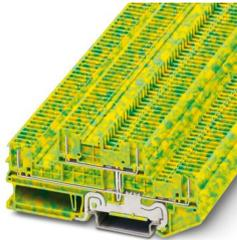
Schutzleiter-Doppelstockklemme, Anzahl der Anschlüsse: 4, Anschlussart: Steckanschluss, 1. und 2. Etage, Querschnitt: 0,14 mm<sup>2</sup> - 1,5 mm<sup>2</sup>, Montageart: NS 35/7,5, NS 35/15, Farbe: grün-gelb
