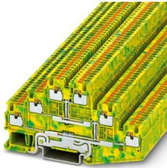
Schutzleiter-Reihenklemme, Nennspannung: 500 V, Nennstrom: 15 A, Anschlussart: Push-in-Anschluss, 1. Etage, Bemessungsquerschnitt: 1,5 mm<sup>2</sup>, Querschnitt: 0,14 mm<sup>2</sup> - 1,5 mm<sup>2</sup>, Montageart: NS 35/7,5, NS 35/15, Farbe: grün-gelb
