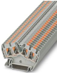
Durchgangsklemme, Nennspannung: 800 V, Nennstrom: 32 A, Anzahl der Anschlüsse: 4, Anschlussart: Push-in-Anschluss, Bemessungsquerschnitt: 4 mm<sup>2</sup>, 1. Etage, Querschnitt: 0,2 mm<sup>2</sup> - 6 mm<sup>2</sup>, Montageart: NS 35/7,5, NS 35/15, Farbe: grau
