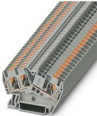
Durchgangsklemme, Nennspannung: 800 V, Nennstrom: 32 A, Anzahl der Anschlüsse: 3, Anschlussart: Push-in-Anschluss, Bemessungsquerschnitt: 4 mm<sup>2</sup>, 1. Etage, Querschnitt: 0,2 mm<sup>2</sup> - 6 mm<sup>2</sup>, Montageart: NS 35/7,5, NS 35/15, Farbe: grau
