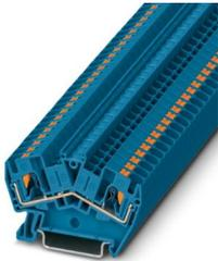
Durchgangsklemme, Nennspannung: 800 V, Nennstrom: 32 A, Anzahl der Anschlüsse: 2, Anschlussart: Push-in-Anschluss, Bemessungsquerschnitt: 4 mm<sup>2</sup>, 1. Etage, Querschnitt: 0,2 mm<sup>2</sup> - 6 mm<sup>2</sup>, Montageart: NS 35/7,5, NS 35/15, Farbe: blau
