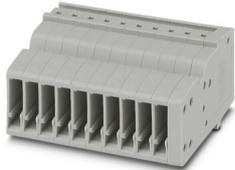
COMBI-Kupplung, Nennspannung: 500 V, Nennstrom: 17,5 A, Anzahl der Anschlüsse: 1, Polzahl: 10, Anschlussart: Push-in-Anschluss, Bemessungsquerschnitt: 1,5 mm<sup>2</sup>, 1. Etage, Querschnitt: 0,14 mm<sup>2</sup> - 1,5 mm<sup>2</sup>, Farbe: grau
