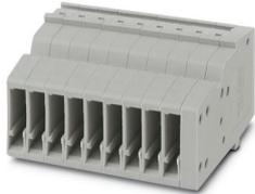
COMBI-Kupplung, Nennspannung: 500 V, Nennstrom: 17,5 A, Anzahl der Anschlüsse: 1, Polzahl: 9, Anschlussart: Push-in-Anschluss, Bemessungsquerschnitt: 1,5 mm<sup>2</sup>, 1. Etage, Querschnitt: 0,14 mm<sup>2</sup> - 1,5 mm<sup>2</sup>, Farbe: grau
