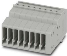
COMBI-Kupplung, Nennspannung: 500 V, Nennstrom: 17,5 A, Anzahl der Anschlüsse: 1, Polzahl: 8, Anschlussart: Push-in-Anschluss, Bemessungsquerschnitt: 1,5 mm<sup>2</sup>, 1. Etage, Querschnitt: 0,14 mm<sup>2</sup> - 1,5 mm<sup>2</sup>, Farbe: grau
