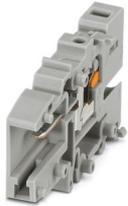
COMBI-Kupplung, Nennspannung: 500 V, Nennstrom: 17,5 A, Anzahl der Anschlüsse: 1, Polzahl: 1, Anschlussart: Push-in-Anschluss, Bemessungsquerschnitt: 1,5 mm<sup>2</sup>, 1. Etage, Querschnitt: 0,14 mm<sup>2</sup> - 1,5 mm<sup>2</sup>, Farbe: grau
