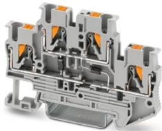
Bauelementreihenklamme, mit integrierter Diode 1N4007, Nennstrom: 0,5 A, Anzahl der Anschlüsse: 4, Anschlussart: Push-in-Anschluss, Bemessungsquerschnitt: 2,5 mm<sup>2</sup>, 1. und 2. Etage, Querschnitt: 0,14 mm<sup>2</sup> - 4 mm<sup>2</sup>, Montageart: NS 35/7,5, NS 35/15, Farbe: grau
