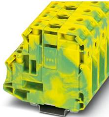
Schutzleiter-Reihenklemme, Anzahl der Anschlüsse: 5, Polzahl: 1, Anschlussart: Schraubanschluss, Bemessungsquerschnitt: 70 mm<sup>2</sup>, Querschnitt: 16 mm<sup>2</sup> - 95 mm<sup>2</sup>, Anschlussart: Schraubanschluss, Querschnitt: 1,5 mm<sup>2</sup> - 16 mm<sup>2</sup>, Befestigungsart: PE-Fuß mit Befestigungsschraube, M6, Montageart: NS 35/7,5, NS 35/15, NS 35/15-2,3, NS 32, Farbe: grün-gelb
