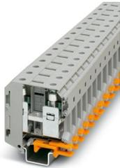
Hochstromklemme, Nennspannung: 1000 V, Nennstrom: 192 A, Anzahl der Anschlüsse: 2, Polzahl: 1, Anschlussart: Schraubanschluss, Bemessungsquerschnitt: 70 mm<sup>2</sup>, Querschnitt: 16 mm<sup>2</sup> - 95 mm<sup>2</sup>, Montageart: NS 35/7,5, NS 35/15, NS 35/15-2,3, NS 32, Farbe: grau
