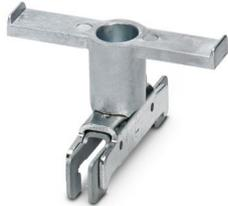
Auflagebock, Halterung für Sammelschienen, alle 20 cm zu setzen, Tiefe: 33,7 mm, Breite: 56 mm, Höhe: 50 mm, Polzahl: 2, Farbe: silberfarben, Montageart: Tragschienenmontage
