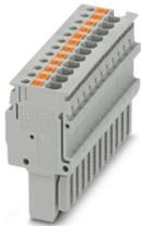
Stecker, Nennspannung: 500 V, Nennstrom: 17,5 A, Anzahl der Anschlüsse: 12, Polzahl: 12, Anschlussart: Push-in-Anschluss, Bemessungsquerschnitt: 1,5 mm<sup>2</sup>, 1. Etage, Querschnitt: 0,14 mm<sup>2</sup> - 1,5 mm<sup>2</sup>, Farbe: grau
