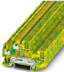
Schutzleiter-Doppelstockklemme, Anzahl der Anschlüsse: 4, Anschlussart: Push-in- / Steckanschluss, 1. und 2. Etage, Querschnitt: 0,14 mm<sup>2</sup> - 1,5 mm<sup>2</sup>, Montageart: NS 35/7,5, NS 35/15, Farbe: grün/gelb
