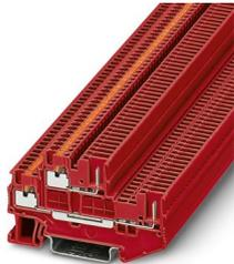
Doppelstockklemme, Strom und Spannung werden durch den eingesetzten Stecker bestimmt., Nennspannung: 500 V, Nennstrom: 16 A, Anschlussart: Push-in- / Steckanschluss, 1. und 2. Etage, Bemessungsquerschnitt: 1,5 mm<sup>2</sup>, Querschnitt: 0,14 mm<sup>2</sup> - 1,5 mm<sup>2</sup>, Montageart: NS 35/7,5, NS 35/15, Farbe: rot
