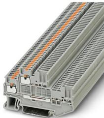
Doppelstockklemme, Strom und Spannung werden durch den eingesetzten Stecker bestimmt., Nennspannung: 500 V, Nennstrom: 16 A, Anschlussart: Push-in- / Steckanschluss, 1. und 2. Etage, Bemessungsquerschnitt: 1,5 mm<sup>2</sup>, Querschnitt: 0,14 mm<sup>2</sup> - 1,5 mm<sup>2</sup>, Montageart: NS 35/7,5, NS 35/15, Farbe: grau
