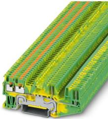
Schutzleiter-Reihenklemme, Anzahl der Anschlüsse: 4, Anschlussart: Push-in- / Steckanschluss, 1. Etage, Querschnitt: 0,14 mm<sup>2</sup> - 1,5 mm<sup>2</sup>, Montageart: NS 35/7,5, NS 35/15, Farbe: grün-gelb
