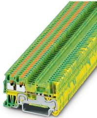
Schutzleiter-Reihenklemme, Anzahl der Anschlüsse: 3, Anschlussart: Push-in- / Steckanschluss, 1. Etage, Querschnitt: 0,14 mm<sup>2</sup> - 1,5 mm<sup>2</sup>, Montageart: NS 35/7,5, NS 35/15, Farbe: grün-gelb
