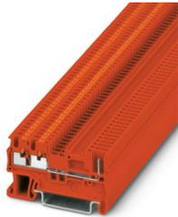
Durchgangsklemme, Nennspannung: 500 V, Nennstrom: 17,5 A, Anzahl der Anschlüsse: 3, Polzahl: 1, Anschlussart: Push-in- / Steckanschluss, Bemessungsquerschnitt: 1,5 mm<sup>2</sup>, 1. Etage, Querschnitt: 0,14 mm<sup>2</sup> - 1,5 mm<sup>2</sup>, Montageart: NS 35/7,5, NS 35/15, Farbe: rot
