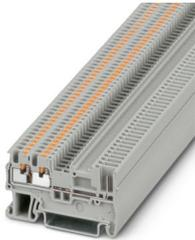
Durchgangsklemme, Nennspannung: 500 V, Nennstrom: 17,5 A, Anzahl der Anschlüsse: 3, Polzahl: 1, Anschlussart: Push-in- / Steckanschluss, Bemessungsquerschnitt: 1,5 mm<sup>2</sup>, 1. Etage, Querschnitt: 0,14 mm<sup>2</sup> - 1,5 mm<sup>2</sup>, Montageart: NS 35/7,5, NS 35/15, Farbe: grau
