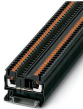
Durchgangsklemme, Nennspannung: 800 V, Nennstrom: 24 A, Anzahl der Anschlüsse: 2, Polzahl: 1, Anschlussart: Push-in-Anschluss, Bemessungsquerschnitt: 2,5 mm<sup>2</sup>, Querschnitt: 0,14 mm<sup>2</sup> - 4 mm<sup>2</sup>, Montageart: NS 35/7,5, NS 35/15, Farbe: schwarz
