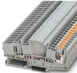
Durchgangsklemme, Nennspannung: 500 V, Nennstrom: 30 A, Anschlussart: Push-in-Anschluss, 1. Etage, Bemessungsquerschnitt: 6 mm<sup>2</sup>, Querschnitt: 0,5 mm<sup>2</sup> - 10 mm<sup>2</sup>, Farbe: grau
