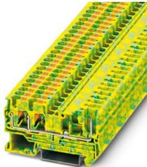
Schutzleiter-Reihenklemme, Anschlussart: Push-in- / Steckanschluss, Bemessungsquerschnitt: 4 mm<sup>2</sup>, Querschnitt: 0,2 mm<sup>2</sup> - 6 mm<sup>2</sup>, Montage: NS 35/7,5, NS 35/15, Farbe: grün-gelb
