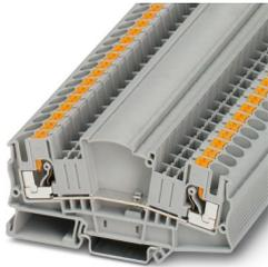
Durchgangsklemme, Nennspannung: 1000 V, Nennstrom: 41 A, Anschlussart: Push-in-Anschluss, 1. Etage, Bemessungsquerschnitt: 6 mm<sup>2</sup>, Querschnitt: 0,5 mm<sup>2</sup> - 10 mm<sup>2</sup>, Farbe: grau
