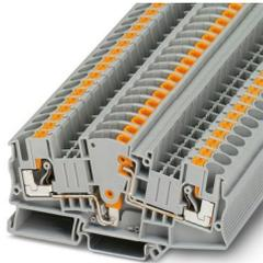
Messwandler-Trennklemme, Nennspannung: 500 V, Nennstrom: 30 A, Anschlussart: Push-in-Anschluss, 1. Etage, Bemessungsquerschnitt: 6 mm<sup>2</sup>, Querschnitt: 0,5 mm<sup>2</sup> - 10 mm<sup>2</sup>, Farbe: grau
