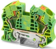
Schutzleiter-Reihenklemme, Anzahl der Anschlüsse: 2, Anschlussart: Push-in-Anschluss, Bemessungsquerschnitt: 16 mm<sup>2</sup>, Querschnitt: 0,5 mm<sup>2</sup> - 25 mm<sup>2</sup>, Montageart: NS 35/7,5, NS 35/15, Farbe: grün-gelb
