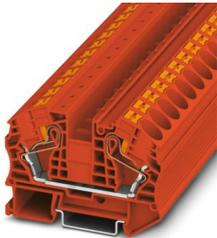
Durchgangsklemme, Nennspannung: 1000 V, Nennstrom: 76 A, Anzahl der Anschlüsse: 2, Anschlussart: Push-in-Anschluss, Bemessungsquerschnitt: 16 mm<sup>2</sup>, Querschnitt: 0,5 mm<sup>2</sup> - 25 mm<sup>2</sup>, Montageart: NS 35/7,5, NS 35/15, Farbe: rot
