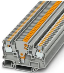
Messwandler-Trennklemme, Nennspannung: 500 V, Nennstrom: 24 A, Anzahl der Anschlüsse: 2, Anschlussart: Push-in-Anschluss, Bemessungsquerschnitt: 4 mm<sup>2</sup>, 1. Etage, Querschnitt: 0,2 mm<sup>2</sup> - 6 mm<sup>2</sup>, Montageart: NS 35/7,5, NS 35/15, Farbe: grau
