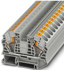
Durchgangsklemme, Nennspannung: 1000 V, Nennstrom: 76 A, Anzahl der Anschlüsse: 2, Anschlussart: Push-in-Anschluss, Bemessungsquerschnitt: 16 mm<sup>2</sup>, Querschnitt: 0,5 mm<sup>2</sup> - 25 mm<sup>2</sup>, Montageart: NS 35/7,5, NS 35/15, Farbe: grau
