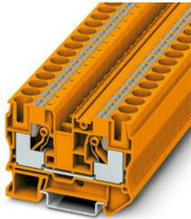
Durchgangsklemme, Nennspannung: 1000 V, Nennstrom: 57 A, Anzahl der Anschlüsse: 2, Anschlussart: Push-in-Anschluss, Bemessungsquerschnitt: 10 mm<sup>2</sup>, Querschnitt: 0,5 mm<sup>2</sup> - 16 mm<sup>2</sup>, Montageart: NS 35/7,5, NS 35/15, Farbe: orange
