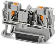
Bauelementreihenklemme, Der max. Strom wird durch die Diode bestimmt. Eingebaut: Diode 1N 5408, Sperrspannung: 1000 V, Dauergrenzstrom: 1,5 A, mit integrierter Diode 1N5408, Nennstrom: 1,5 A, Anschlussart: Push-in-Anschluss, Bemessungsquerschnitt: 1 mm<sup>2</sup>, Querschnitt: 0,2 mm<sup>2</sup> - 6 mm<sup>2</sup>, Montage: NS 35/7,5, NS 35/15, Farbe: grau
