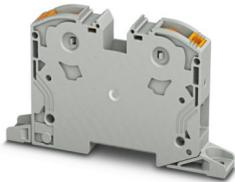
Hochstromklemme, Nennspannung: 1000 V, Nennstrom: 125 A, Anzahl der Anschlüsse: 2, Polzahl: 1, Anschlussart: PowerTurn-Anschluss, Bemessungsquerschnitt: 35 mm<sup>2</sup>, Querschnitt: 2,5 mm<sup>2</sup> - 35 mm<sup>2</sup>, Montageart: direktes Anschrauben, Farbe: grau
