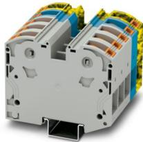
Hochstromklemme, geblockt, Nennspannung: 1000 V, Nennstrom: 125 A, Anzahl der Anschlüsse: 10, Polzahl: 5, Anschlussart: PowerTurn-Anschluss, Bemessungsquerschnitt: 35 mm<sup>2</sup>, Querschnitt: 2,5 mm<sup>2</sup> - 35 mm<sup>2</sup>, Montageart: NS 35/15, Farbe: grau/blau/schwarz-gelb
