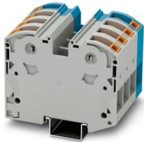
Hochstromklemme, geblockt, Nennspannung: 1000 V, Nennstrom: 125 A, Anzahl der Anschlüsse: 8, Polzahl: 4, Anschlussart: PowerTurn-Anschluss, Bemessungsquerschnitt: 35 mm<sup>2</sup>, Querschnitt: 2,5 mm<sup>2</sup> - 35 mm<sup>2</sup>, Montageart: NS 35/15, Farbe: grau/blau
