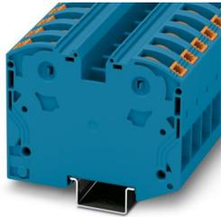
Hochstromklemme, Nennspannung: 1000 V, Nennstrom: 125 A, Anzahl der Anschlüsse: 2, Anschlussart: PowerTurn-Anschluss, Bemessungsquerschnitt: 35 mm<sup>2</sup>, Querschnitt: 2,5 mm<sup>2</sup> - 35 mm<sup>2</sup>, Montageart: NS 35/15, Farbe: blau
