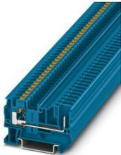
Durchgangsklemme, Nennspannung: 800 V, Nennstrom: 32 A, Anzahl der Anschlüsse: 2, Anschlussart: Push-in- / Steckanschluss, Bemessungsquerschnitt: 4 mm<sup>2</sup>, Querschnitt: 0,2 mm<sup>2</sup> - 6 mm<sup>2</sup>, Montageart: NS 35/7,5, NS 35/15, Farbe: blau
