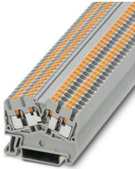
Durchgangsklemme, Nennspannung: 800 V, Nennstrom: 24 A, Anzahl der Anschlüsse: 4, Anschlussart: Push-in-Anschluss, Bemessungsquerschnitt: 2,5 mm<sup>2</sup>, 1. Etage, Querschnitt: 0,14 mm<sup>2</sup> - 4 mm<sup>2</sup>, Montageart: NS 35/7,5, NS 35/15, Farbe: grau
