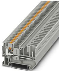
Durchgangsklemme, Nennspannung: 800 V, Nennstrom: 32 A, Anzahl der Anschlüsse: 2, Anschlussart: Push-in- / Steckanschluss, Bemessungsquerschnitt: 4 mm<sup>2</sup>, Querschnitt: 0,2 mm<sup>2</sup> - 6 mm<sup>2</sup>, Montageart: NS 35/7,5, NS 35/15, Farbe: grau
