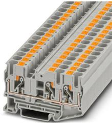
Durchgangsklemme, Nennspannung: 1000 V, Nennstrom: 41 A, Anzahl der Anschlüsse: 3, Anschlussart: Push-in-Anschluss, Bemessungsquerschnitt: 6 mm<sup>2</sup>, Querschnitt: 0,5 mm<sup>2</sup> - 10 mm<sup>2</sup>, Montageart: NS 35/7,5, NS 35/15, Farbe: grau
