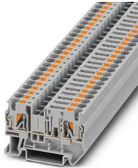
Trennklemme, Strom und Spannung werden durch den eingesetzten Stecker bestimmt., Nennspannung: 500 V, Nennstrom: 20 A, Anschlussart: Push-in-Anschluss, Bemessungsquerschnitt: 4 mm<sup>2</sup>, Querschnitt: 0,2 mm<sup>2</sup> - 6 mm<sup>2</sup>, Montage: NS 35/7,5, NS 35/15, Farbe: grau
