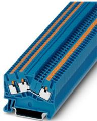
Durchgangsklemme, Nennspannung: 800 V, Nennstrom: 24 A, Anzahl der Anschlüsse: 3, Anschlussart: Push-in-Anschluss, Bemessungsquerschnitt: 2,5 mm<sup>2</sup>, 1. Etage, Querschnitt: 0,14 mm<sup>2</sup> - 4 mm<sup>2</sup>, Montageart: NS 35/7,5, NS 35/15, Farbe: blau
