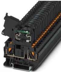
Sicherungsreihenklemme, Art der Sicherung: Glas / Keramik / ..., Sicherungstyp: G / 5 x 20, Nennspannung: 24 V, Nennstrom: 6,3 A, Polzahl: 1, Anschlussart: Push-in-Anschluss, Bemessungsquerschnitt: 4 mm<sup>2</sup>, Querschnitt: 0,2 mm<sup>2</sup>- 6 mm<sup>2</sup>, Montageart: NS 35/7,5, NS 35/15, Farbe: schwarz
