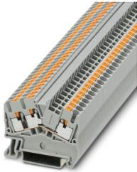
Durchgangsklemme, Nennspannung: 800 V, Nennstrom: 24 A, Anzahl der Anschlüsse: 3, Anschlussart: Push-in-Anschluss, Bemessungsquerschnitt: 2,5 mm<sup>2</sup>, 1. Etage, Querschnitt: 0,14 mm<sup>2</sup> - 4 mm<sup>2</sup>, Montageart: NS 35/7,5, NS 35/15, Farbe: grau
